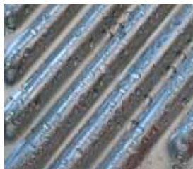
Fig 7: Superficie di scambio termico Inox-Crossal
